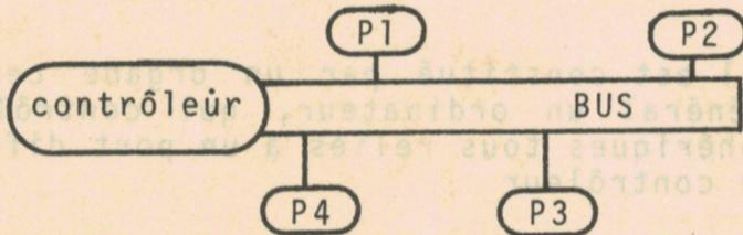
Fig. 2: Réseau autour d'un BUS
