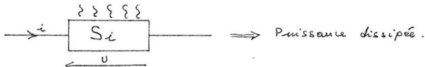
Si la puissance fournie est égale à la puissance dissipée, on dit qu'il y a équilibre thermique. Mais si la puissance fournie est supérieure à la puissance dissipée il y a automatiquement destruction du semi-conducteur.
